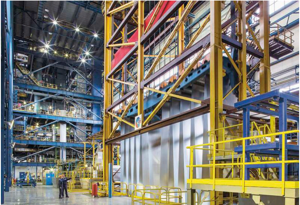
Рис. 10.4.2. Агрегат непрерывного горячего цинкования
