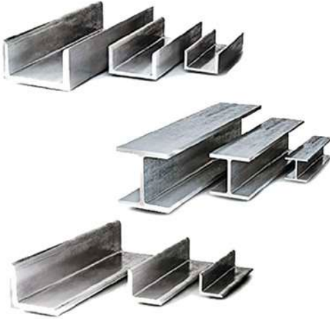
Рис. 1.7.3. Типовые фасонные профили сортового проката (швеллер, двутавр, уголок)
