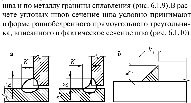
Рис. 6.1.10. Сечение углового шва: а) фактическое; б) расчетное
