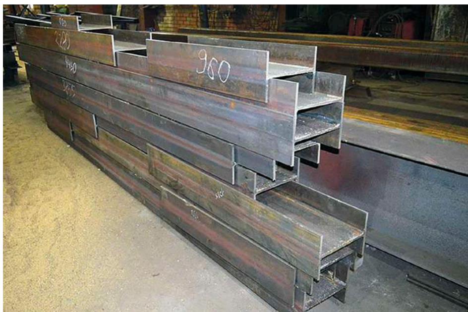
Рис. 1.6.4. Сварные двутавры с параллельными гранями полок из толстолистового проката
