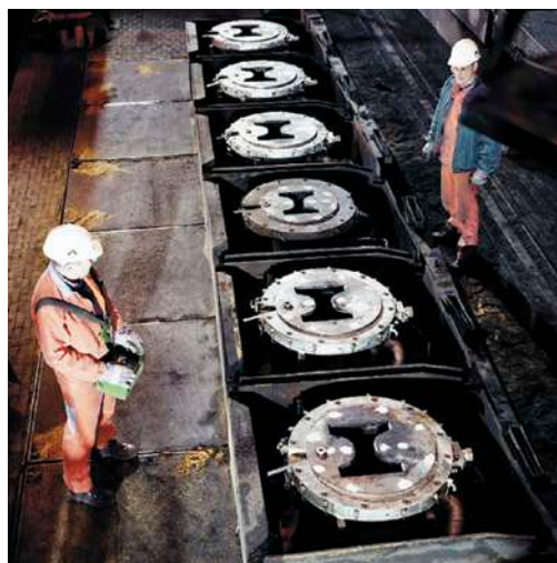
Рис. 1.7.11. Кристаллизаторы МНЛЗ при производстве фасонной непрерывнолитой заготовки типа «собачья кость» для прокатки двутавровой балки
