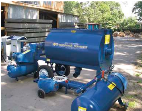
Рис. 8.4.2. Гироторная установка по производству монолитного пенобетона
