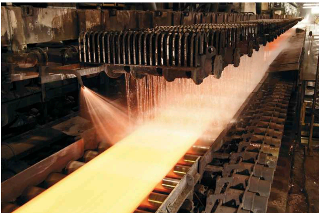
Рис. 1.2.9. Общий вид работы системы ламинарного водяного охлаждения полосы на отводящем рольганге ШПС
