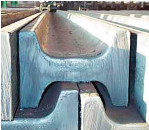
Рис. 1.7.10. Внешний вид непрерывнолитой фасонной заготовки типа «собачья кость» для прокатки двутавровой балки
