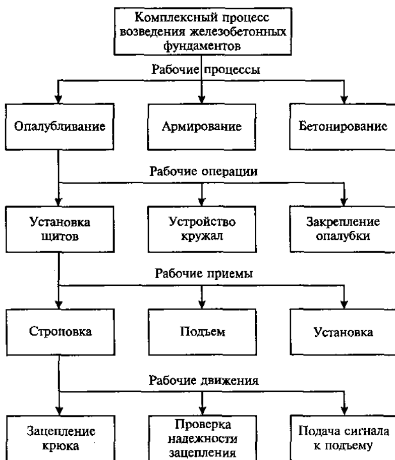
Рис. 1.1. Структурная схема комплексного строительного процесса
