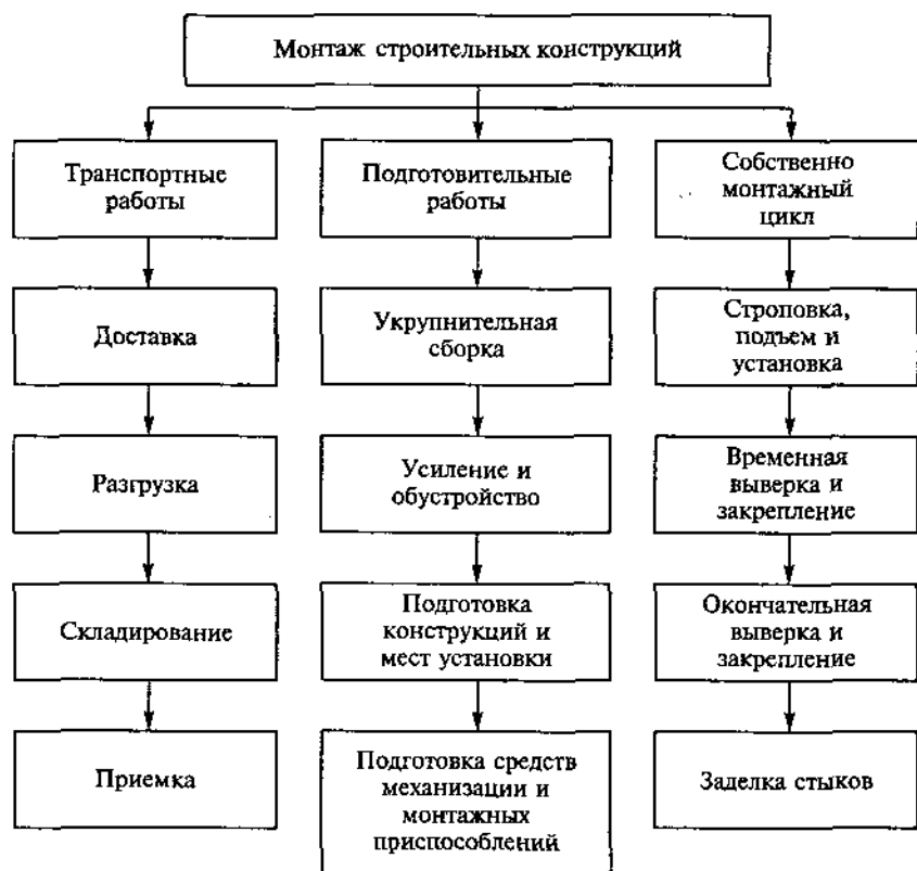
Рис. 11.2. Схема технологического процесса монтажа строительных конструкций
