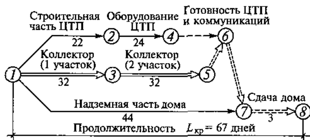
Рис. 16.8 (см. также с. 413). Способы сокращения протяженности критического пути:
