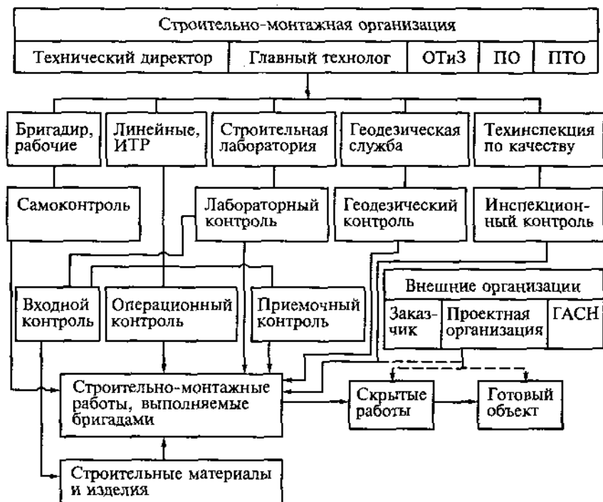
Рис. 19.1. Структурная схема контроля качества службами строительно-монтажных и смежных организаций
