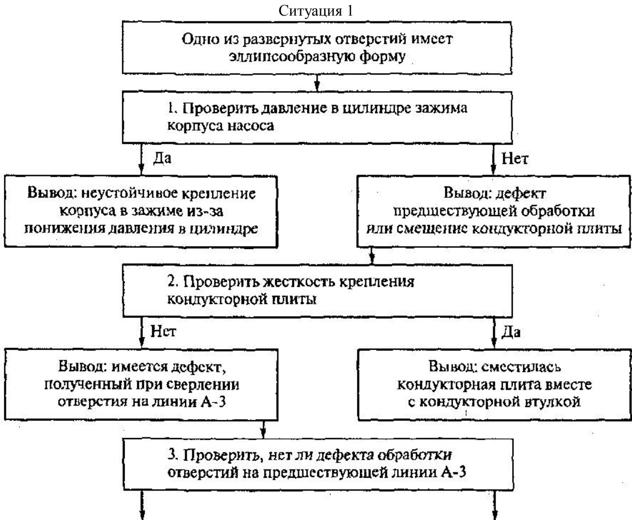
Рис. 1. Алгоритм обучения поиску причин брака при развертывании пяти отверстий в корпусе насоса (фрагмент)
